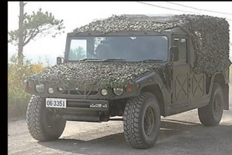
トヨタ自動車が開発した4輪駆動の高性能汎用トラック。一個班程度の作戦行動に適しており、人員輸送のほか資材運搬などさまざまな状況で幅広く運用されている。4WSなどの採用で機動力が非常に高く、一般道での高速走行のほか、悪路でも優れた走行性能を誇り、さまざまな派生型が存在する。愛称は「疾風」だが、高機(こうき)の通称で呼ばれている。
